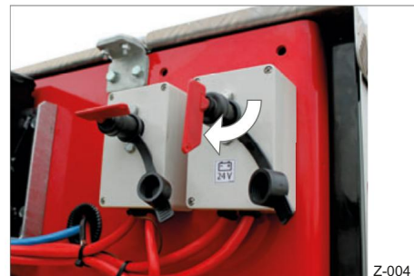
Fig. 8 Mise sous tension des piles (ON)
