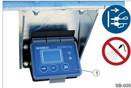
Fig. 8 Dispositif SmartBoard fermé
