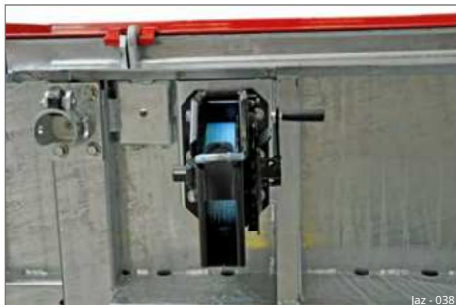
Slika 35 Vitel z napenjalnim trakom (4x), nameščen pod nakladalnim mostom
