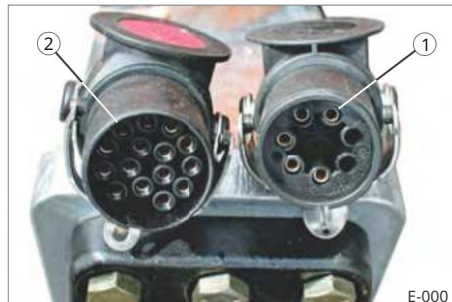
Slika 2 Vtični priključki, standardni 24 V 1 7-pinski EBS/ABS konektor (ISO 7638) 2 15-pinska električna konektorja (ISO 12098)
