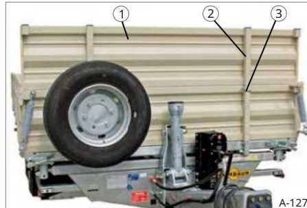
Slika 133 Pritrditev na sprednjo stransko steno
