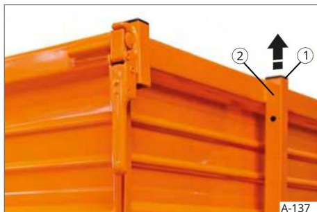
Slika 143 Priprava podpornega stojala za montažo
