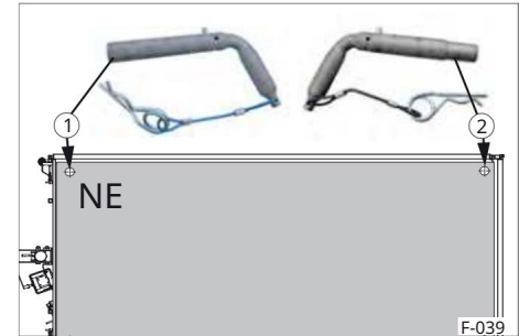
Slika 62 Vtični zatič vstavljen desno v smeri vožnje
