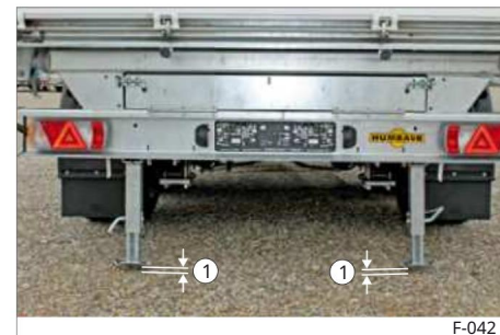
Sl. 65 Zložljiva opora je zložena navzdol 1 Razdalja od tal (približno 3–5 cm)
