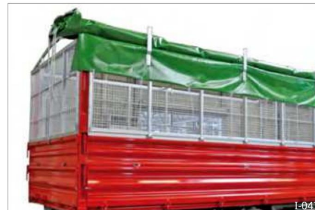
Slika 50 Rolo ponjava na jekleni mrežasti konstrukciji
