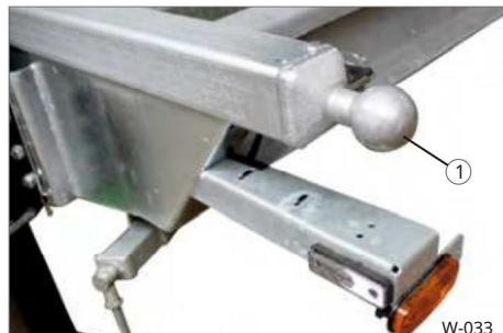
Slika 33 Nagibna kroglica ležaja 1 nagibna kroglica ležaja, varjena
