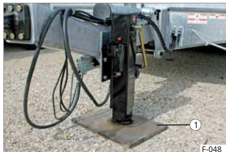
Slika 68 Stabilizirana oporna noga
