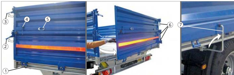
Slika 118 Odpiranje zadnje stranske stene z nastavkom za stransko steno kot vrtljivo krilo
