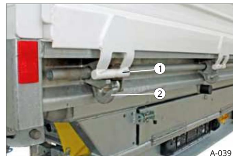
Sl. 47 Odklenjena zadnja vrata prtljažnika
