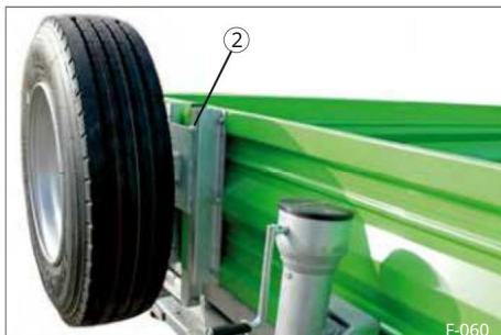
Sl. 83 Rezervno kolo na pregradni steni
