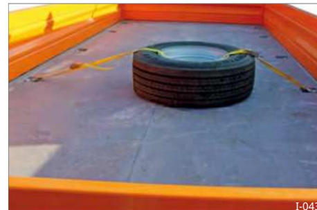
Slika 32 Rezervno kolo ohlapno na nakladalni površini
