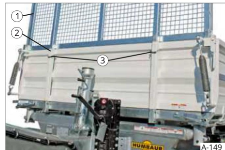
Slika 155 Pritrditev jeklene mreže na sprednji strani
