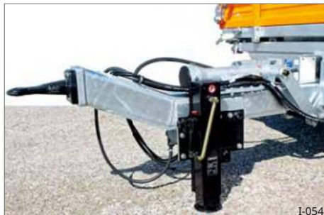
Slika 28 vrtljiva podporna naprava za možnost nakladanja skozi
