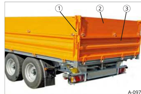
Slika 103 Stranski podaljški sten iz aluminija
