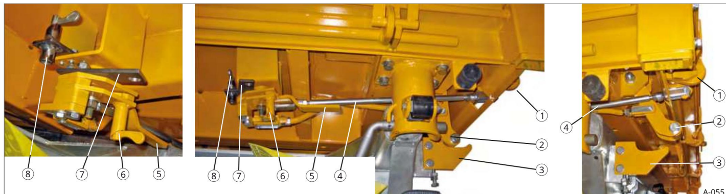
Slika 51 Centralno zaklepanje s polavtomatskim odklepanjem za nihhalno delovanje
