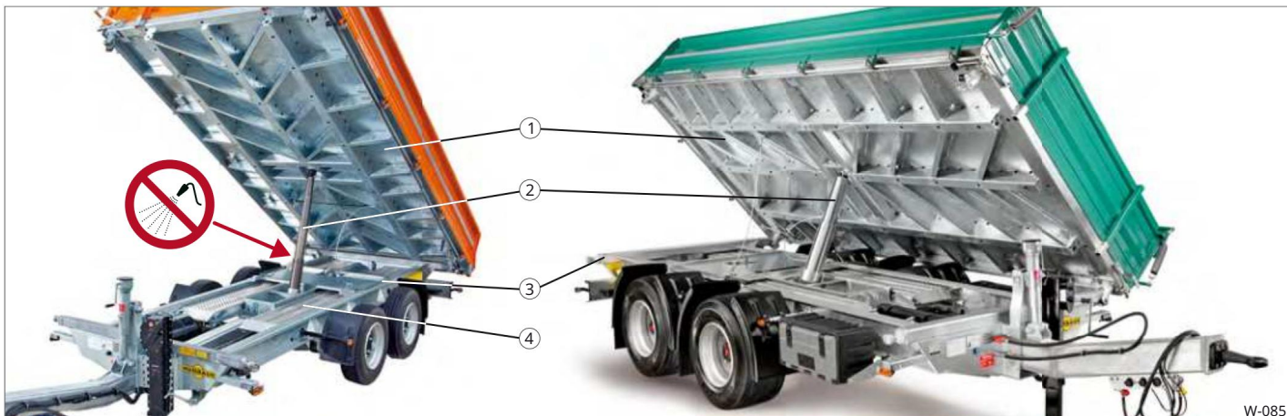
Sl. 83 Čiščenje podvozja/nakladalnega mostu
