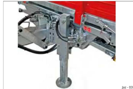
Slika 27 hidravlična podporna naprava
