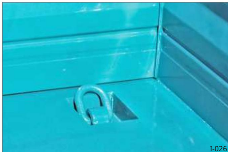
Slika 34 Pritrdilni obroč, zložljiv v žep
