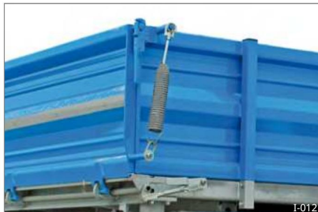
Slika 11 Natezne vzmeti za stranske stene
