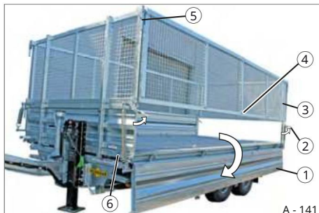
Slika 147 Stranska stena podnožja je prepognjena na stran, pritrditev jeklene mreže se niha
