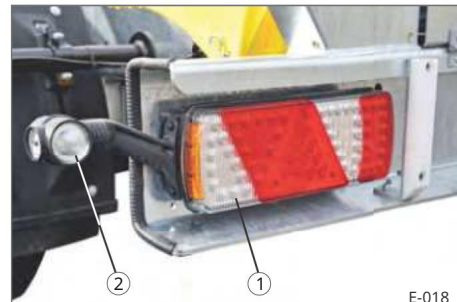
Slika 21 Zadnja osvetlitev "LED" 24 V
