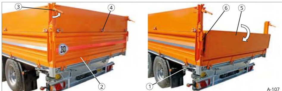
Sl. 114 Podaljšek stranske stene, zadaj zložen navzdol
