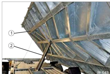
Slika 43 Nakladalni most nagnjen vstran
