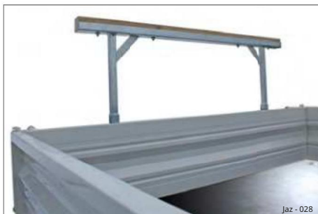
Slika 17 Nosilec na sprednji stranski steni, npr. za žlico kolesnega nakladalnika/bagra
