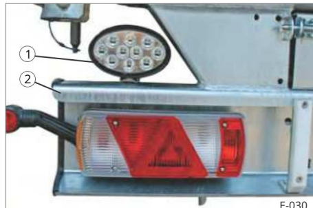
Slika 25 Delovna luč na zadnji strani; osvetlitev desne in leve strani
