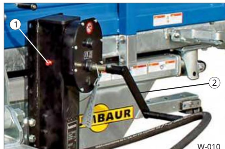
Slika 10 Zobniško podvozje na šasiji
