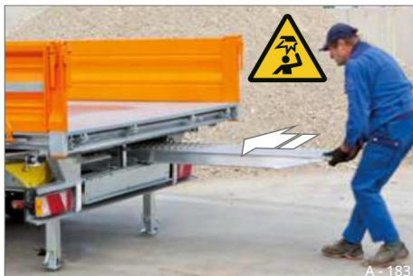
Slika 194 Vstavljanje nakladalnih ramp
