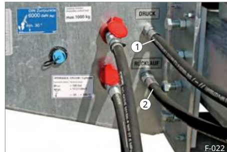
Slika 46 Hidravlika kot dvokrožni sistem
