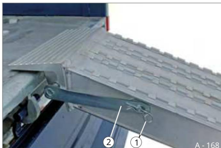
Slika 179 Zavarujte varnostno ročico 1 vzmetni zatič 2 varnostni ročici
