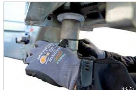
Slika 34 Napenjalne ušesce D50 pritrjene
