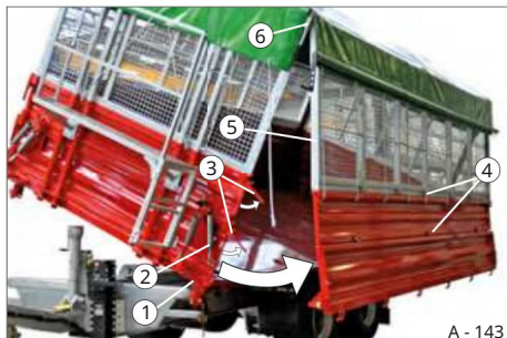
Slika 149 Osnovna stranska stena z jekleno mrežo, ki se niha v stran
