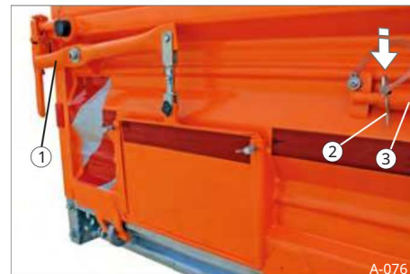
Slika 98 Zavarovana upravljalna ročica
