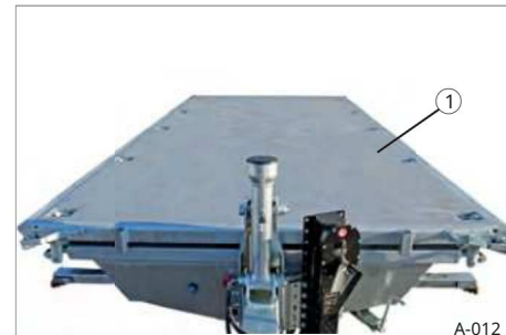
Slika 14 Demontirane stranske stene
