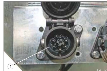
Slika 16 Vtičnica EBS/ABS spodaj levo
