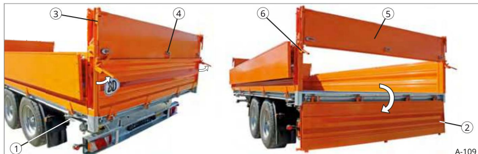
Sl. 115 Zadnja stranska stena zložena / pritrditev stranske stene nihajna
