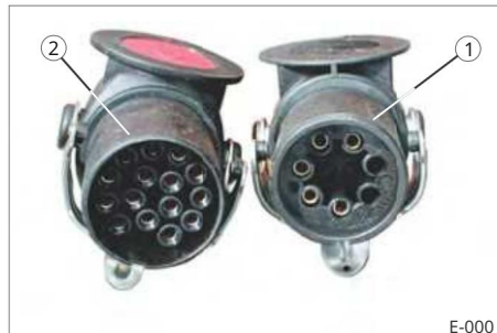
Sl. 7 Utični spojevi, standardni 24 V 1 7-pinski EBS/ABS konektor (ISO 7638) 2 15-pinska električna konektora (ISO 12098)
