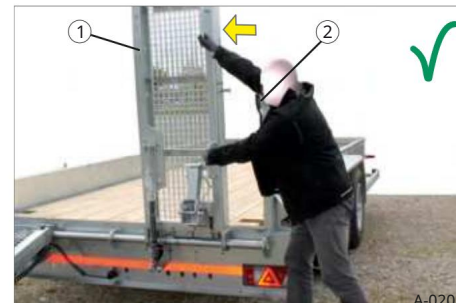
Sl. 22 Pomicanje pristupne rampe
