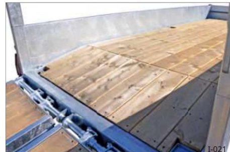
Sl. 21 Drvene daske (smrekovo drvo 40 mm)
