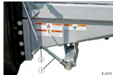
Sl. 48 Kočnica za parkiranje vretena osigurana 1 kurbla 2 sigurnosna užeta s kukama
