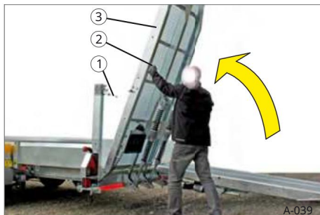
Sl. 41 Podizanje pristupne rampe u jednom komadu
