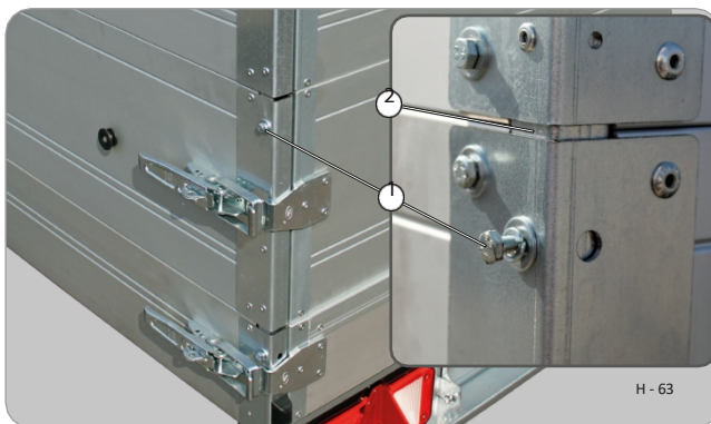
Fäste för sidovägg säkrat
