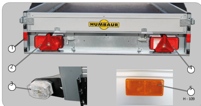
Belysningsarmaturer/markeringar på släpvagnen
