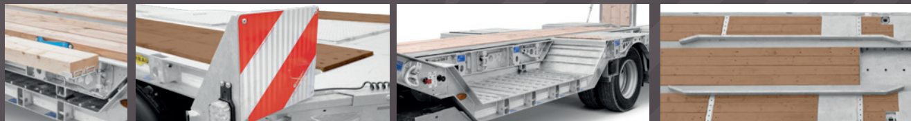
3-Meter-Ausrüstungspaket – Klappausleger und Holzbohlen, gestrichen/imprägniert Ausziehbare Warntafeln mit Beleuchtung Radmulden Ladegutsicherungsschienen
