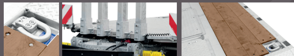
Versenkter Zurrpunkt bis 10t Zugkraft
