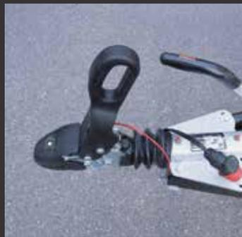
Sicherheitskupplung mit Spurstabilisierung
