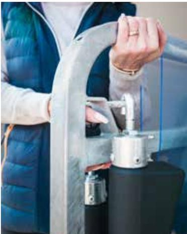
Die verriegelbare Trennwand **EquiLock®** bietet auch bei geöffneter Heckklappe absolute Sicherheit für Ihre Vierbeiner. In Paniksituationen lässt sich die Trennwand nicht unabsichtlich verschieben, da die mechanische Verriegelung ein nach oben Drücken der Heckstangen effektiv verhindert. So kann die Trennwand, auch bei offener Heckklappe, nicht ausgehebelt werden, wodurch die Verletzungsgefahr der Pferde im Anhänger deutlich reduziert wird.
