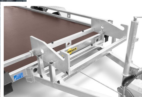
Support de godet de pelle sur le timon en V (en option)
