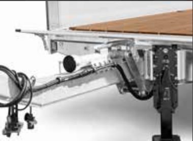
Barre d'attelage pour différentes longueurs et hauteurs d'attelage
