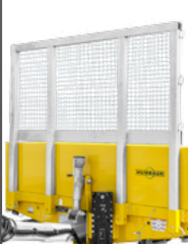
Paroi frontale massive en caillebotis en acier
