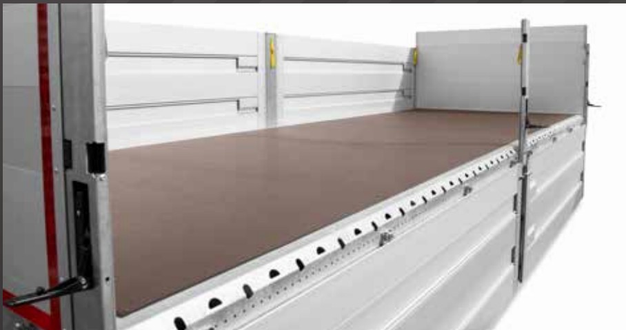
Plancher en bois de 40 mm
