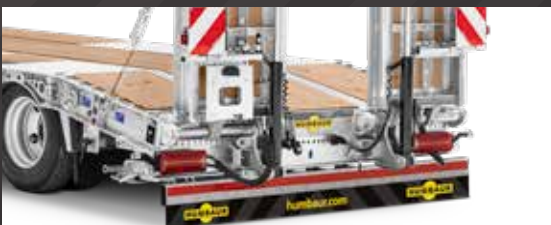
Rampes en 1 partie avec cric de rampe hydraulique
