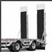
Revêtement de sol en caoutchouc sur panneaux en aluminium pour les rampes
