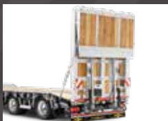
Pont arrière en 2 parties sur toute la largeur, avec revêtement en planches de bois
