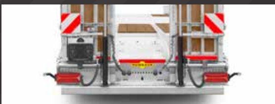
Rampes en 1 partie avec cric de rampe hydraulique
