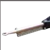
Flèche de remorque réglable en longueur au cadre extérieur
