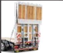
Pont arrière en 2 parties sur toute la largeur, avec revêtement en planches de bois
