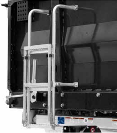
Échelle d'accès sur paroi frontale
