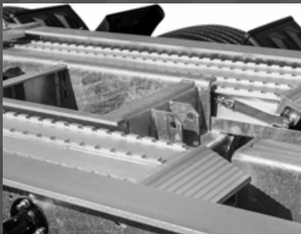
Rampes d'accès en aluminium avec système de verrouillage breveté
