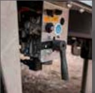
Suspension pneumatique avec dispositif de levage et d'abaissement
