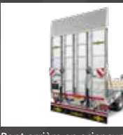
Pont arrière en acier sur toute la largeur avec revêtement en caillbotis
