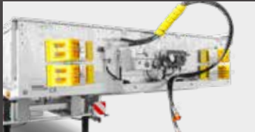
Connexions pour l'alimentation en air et en électricité du véhicule tracteur sur la paroi frontale
