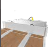
Ridelles en aluminium sur plateau surélévé avec coffre de rangement
