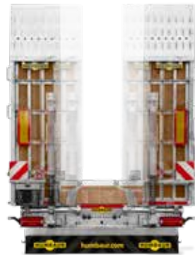
Réglage immédiat de différentes largeurs d'accès, mécanique ou hydraulique en option
