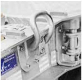
Les anneaux d'arrimage latéraux restent dans la position souhaitée et sont donc facilement accessibles depuis la zone de chargement.
