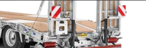
Rampes en 1 partie avec cric de rampe hydraulique
