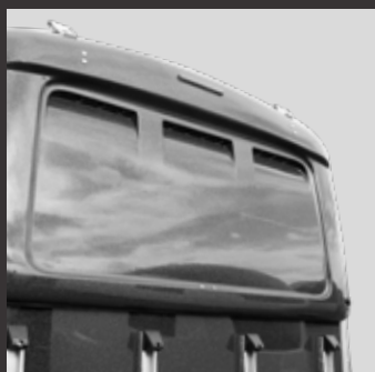
Windklep van met glasvezel versterkt kunststof met geïntegreerd derde remlicht (optioneel) voor Xanthos®, Zephir® en Maximus®
