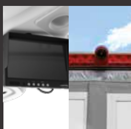
Monitor voor de achteruitrijcamera in de cabine + derde remlicht met geïntegreerde achteruitrijcamera
