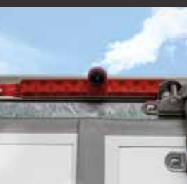
3e remlicht met geïntegreerde achteruitrijcamera
