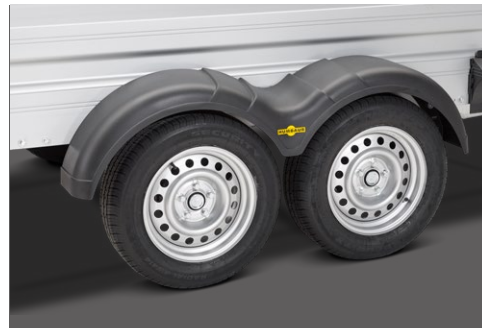
Aerodynamische spatborden van kunststof
