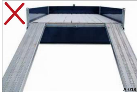
Afbeelding 23 Laadbruggen - te ver naar voren
