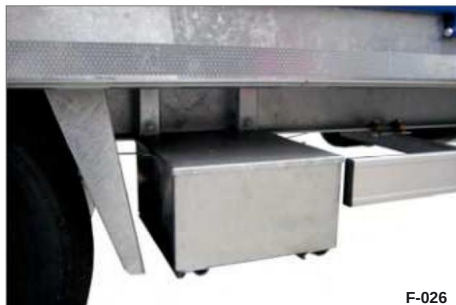
Afbeelding 43 Accubak aan de zijkant onder het chassis
