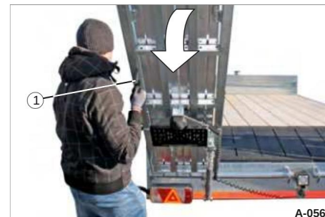
Afbeelding 90 Het verlagen van de toegangsramp
