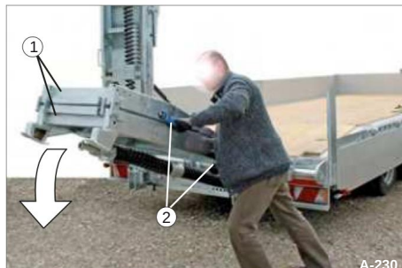
Afbeelding 94 Het verlagen van de toegangsramp
