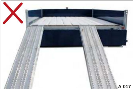
Afbeelding 22 Hellingen - niet proportioneel gepositioneerd
