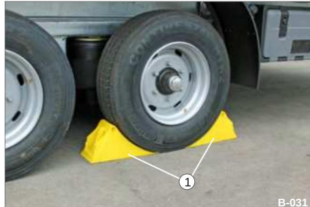
Afbeelding 20 Aanhangwagen vastgezet 1 wielblokken eronder geplaatst
