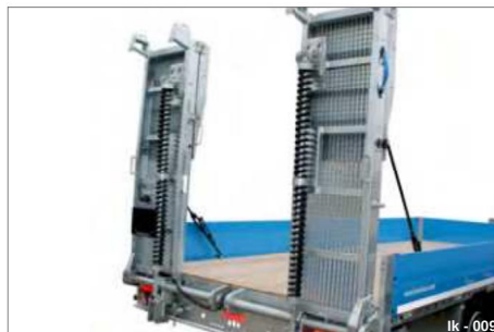
Afbeelding 8 1/3 verdeling, met veerhefmechanisme
