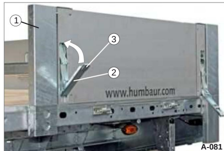
Afbeelding 127 Sluiten van de zijwand
