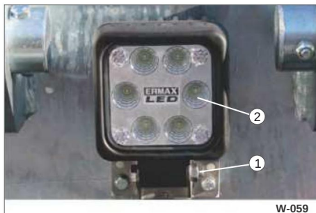
Afbeelding 69 Werklamp aan de achterzijde
