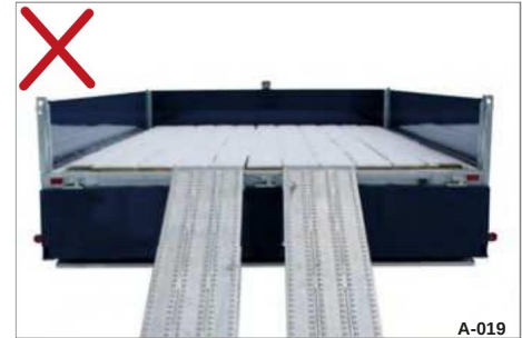
Afbeelding 24 Laadbruggen - te ver naar binnen
