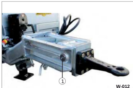
Afbeelding 15 Smeren van de zwenkas 1 smeernippel (met beschermkap)
