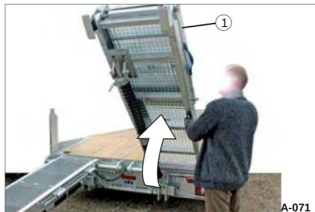
Afbeelding 108 Het optillen van de toegangsram্প in twee delen 1 toegangsram্প
