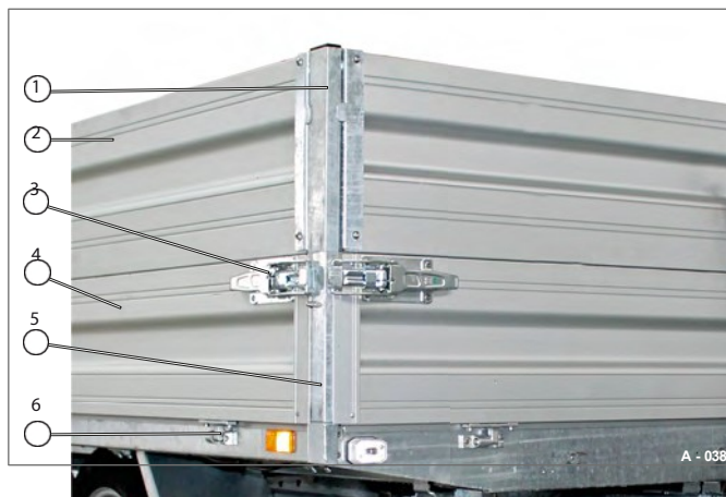
Fig. 29 Uitbreiding aan de zijkant gemonteerd
