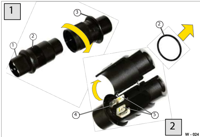
Fig. 28 De kabel aansluiten op de stekker van de acculader
