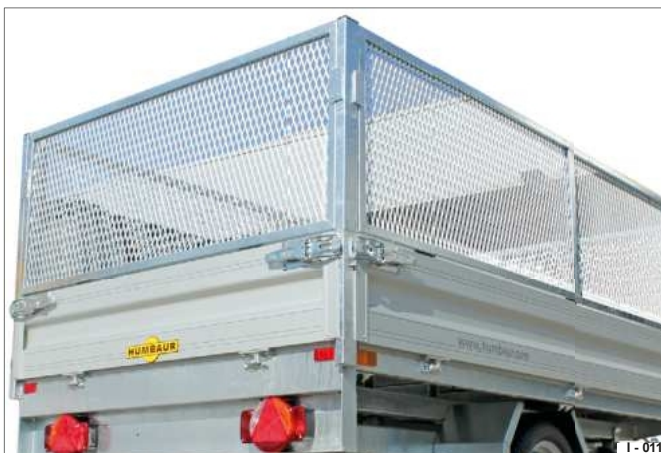
Fig. 12 Opgehangen in hoekankers
