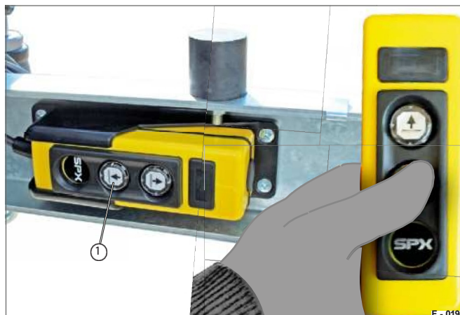
Fig. 24 Dalen met elektrohydraulische pomp
