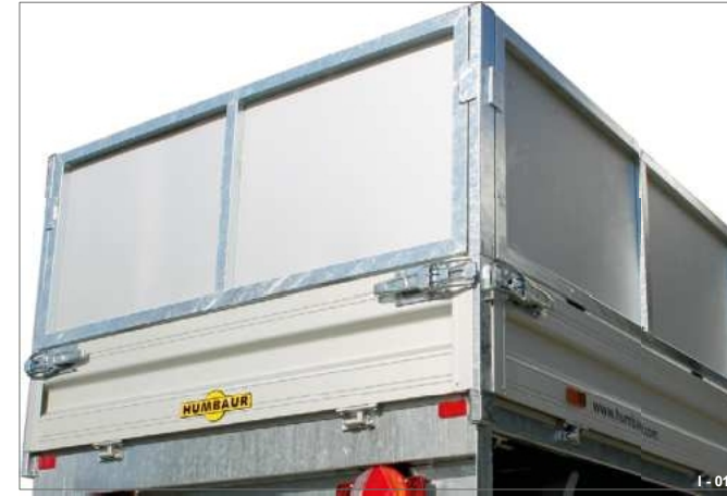
Fig. 13 Opgehangen in hoekankers
