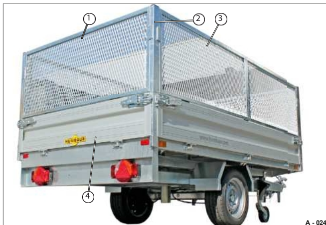
Fig. 31 Stalen roosterbevestiging, vierzijdig
