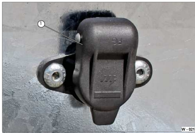
Fig. 25 Aansluiting batterijlader, gedemonteerd
