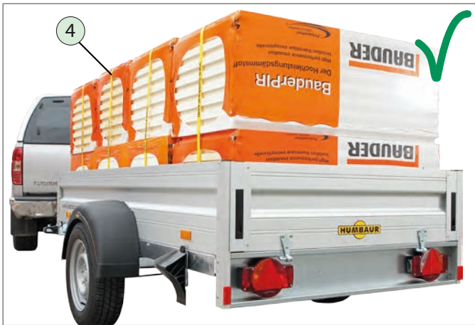
Door vormgeslotenheid en neerwaartse vastsjorring vastgezet
