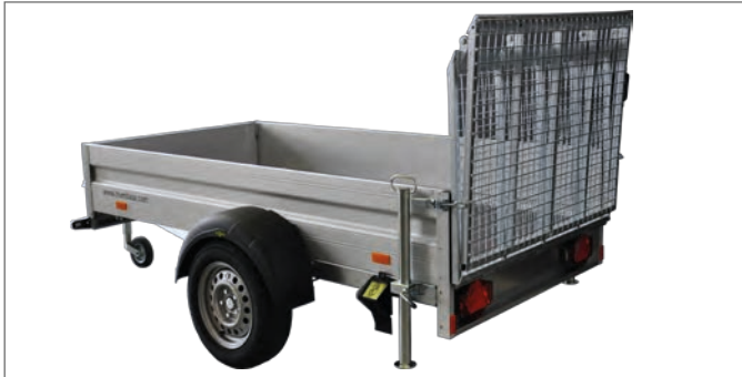
HA met laadwand (stalen rooster) - vastgezet
