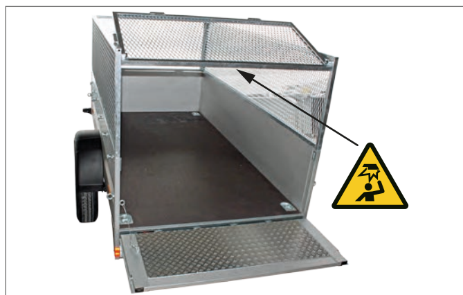
Opzetstuk voor stalen rooster / achterste boordwand geopend
