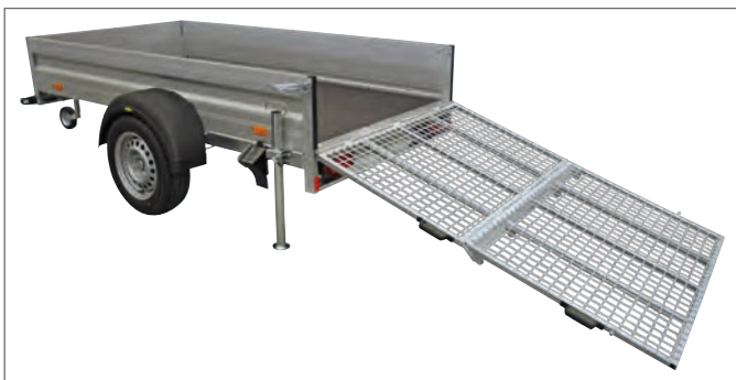
HA met laadwand (stalen rooster) - neergelaten
