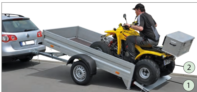
Laadvlak met klein voertuig laden / lossen
