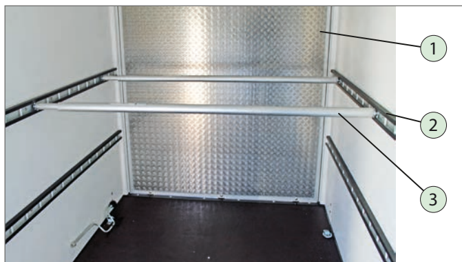
Staafsjorrail met aangebrachte ronde blokkeerstang
