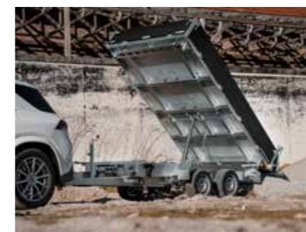
De HTK kan in slechts enkele handelingen naar achteren en opzij kantelen.
