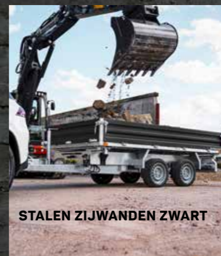
VERZINKTE STALEN ZIJWAND, 400 mm hoog Nog meer stabiliteit bij zware ladingen
