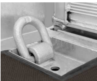
Zurrpunkte im Brückenboden versenkt
