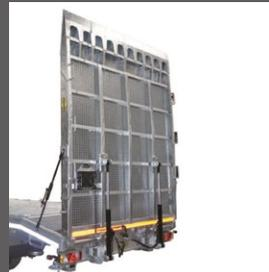
Hydraulische Überfahrwand mit
