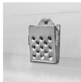
Klapptritt an der Heckklappe
