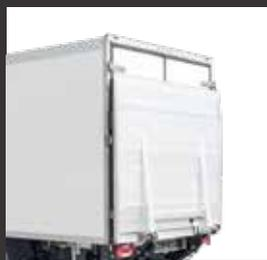
Plateforme élévatrice devant la porte arrière (constructeur différent)
