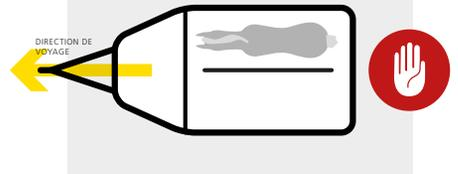
Lors de trajets sur **des routes dont le bas-côté n'est pas sécurisé**, le van peut basculer. Cela a une influence négative sur le **comportement de freinage**. En outre, le van penche plus rapidement, ce qui entraîne **une perte de contrôle et un dérapage**.
