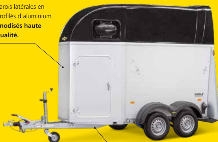
Châssis soudé galvanisé à chaud par immersion et doté d'un timon en V vissé.
