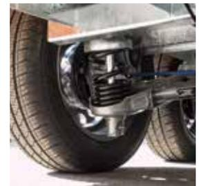
Suspension à ressort hélicoïdal **EquiDrive® PLUS S**
