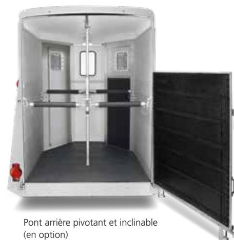
**Pont arrière pivotant et inclinable**
