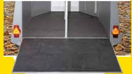
Les vans pour chevaux sont souvent garés dans des champs. Avec le temps, cet environnement brumeux et humide attaque le plancher du van. Il est donc préférable de stationner le van sur une voie goudronnée. Une **imperméabilisation du plancher avec de la cire protectrice** offre également une protection supplémentaire.
