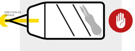
**Le van penche vers l'arrière**, le véhicule tracteur penche vers l'avant = la charge d'appui est trop faible ou négative.
