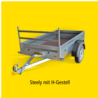
Feuerverzinkte V-Zugdeichsel mit Querstrebe
