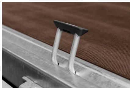
Direkt im Außenrahmen integrierte Zurringe (4 Stück)
