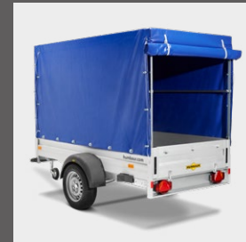
Plane & Spriegel, Ladehöhe 1000/1300/1600/1800 mm (Ausführung je nach Modell)
