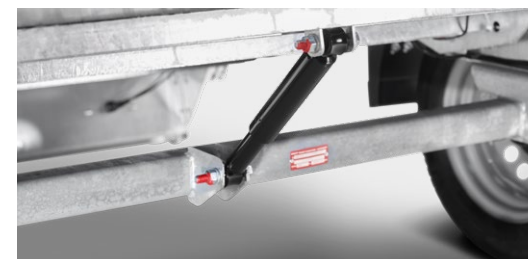
Kippbarer Kastenaufbau (beim HA kippbar) mit Stoßdämpferunterstützung
