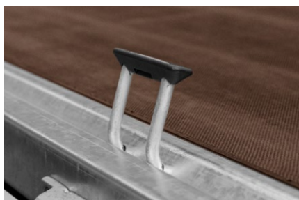
V-Nut Außenrahmen mit 2 Paar versenkten Zurrbügeln
