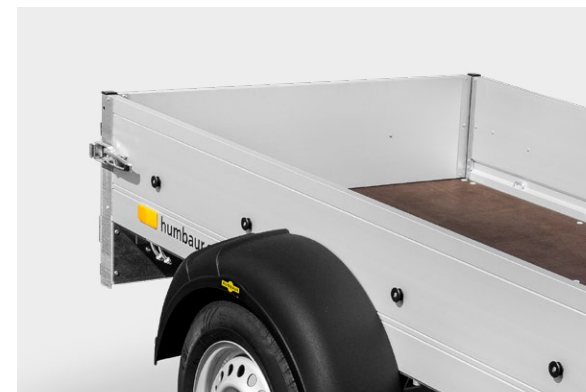
Bordwände aus eloxiertem, doppelwandigem Aluminiumprofil
