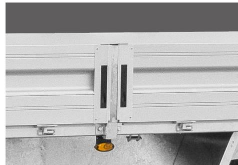
Supports centraux montés sur les parois latérales divisées (avec une paroi intérieure de 6100 mm de long)
