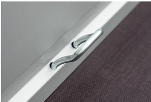
3 paires d'anneaux d'arrimage intégrés dans les ridelles latérales, chacun avec une force de traction de 400 kg
