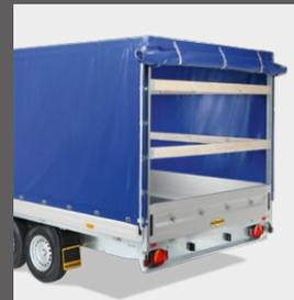
Bâche et arceaux, hauteur de chargement 1300 mm, 1600 mm, 1800 mm, 2000 mm
