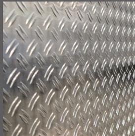
Plaque inférieure avec tôle striée en aluminium
