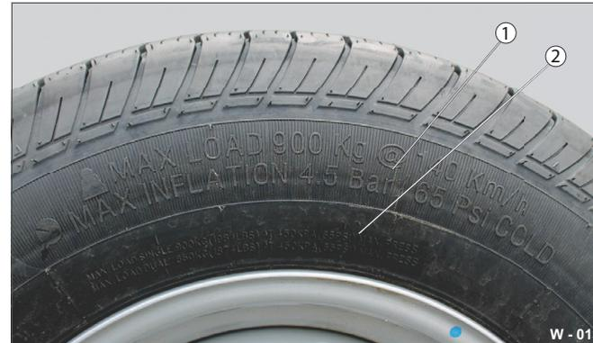
Fig. 15 Pression des pneus – indications
