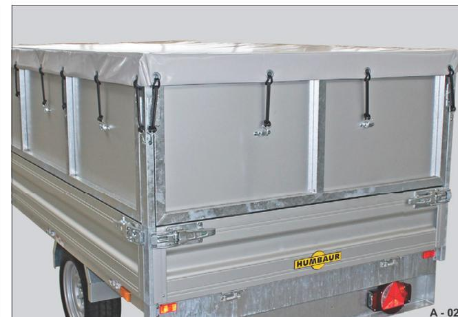
Fig. 50 Sur rehausse en aluminium
