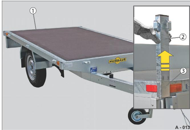
Fig. 14 Ridelles démontées, montants d'angle retirés
