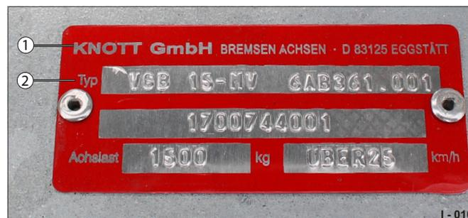
Fig. 24 Exemple : plaque signalétique essieu Knott non freiné
