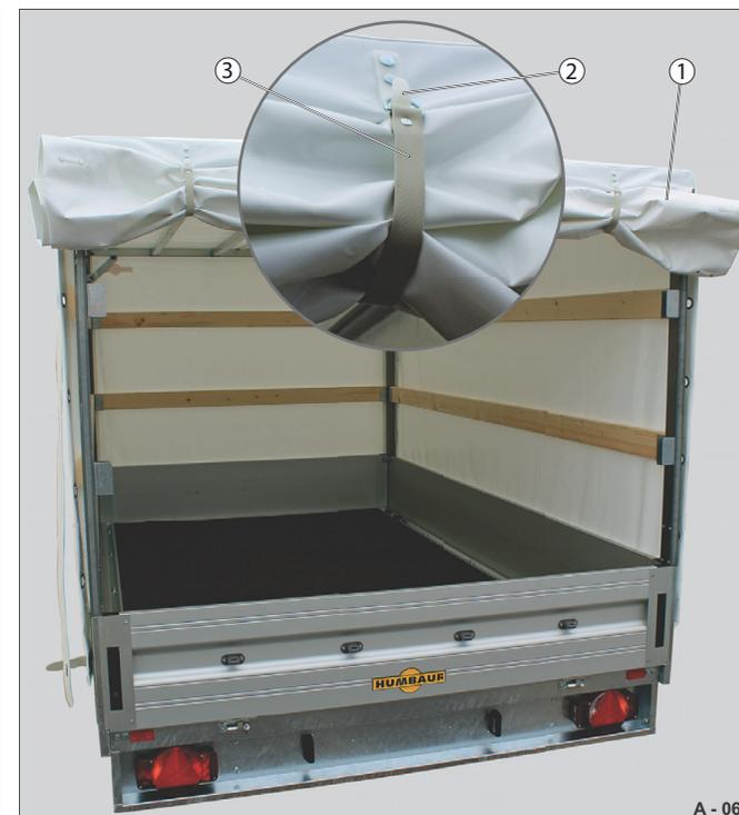
Fig. 77 Face arrière / bâche haute ouverte
