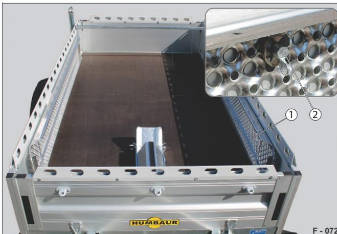
**Fig. 75** Exemple : HA-Allrounder, rails de chargement sécurisés
