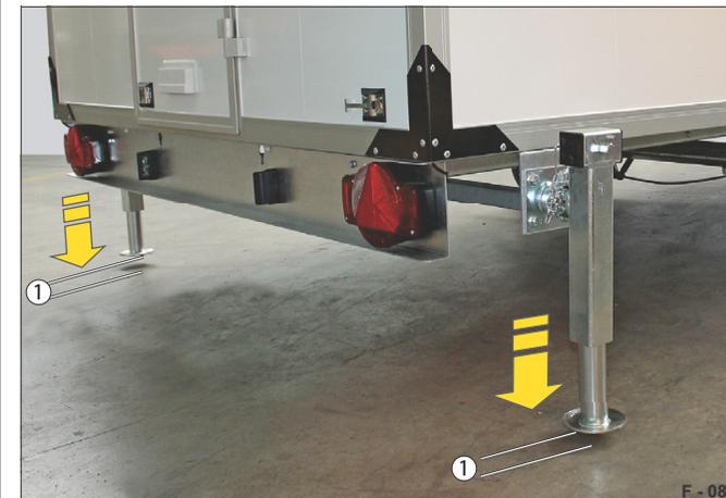
Fig. 20 Positionnement des béquilles en vue du chargement
