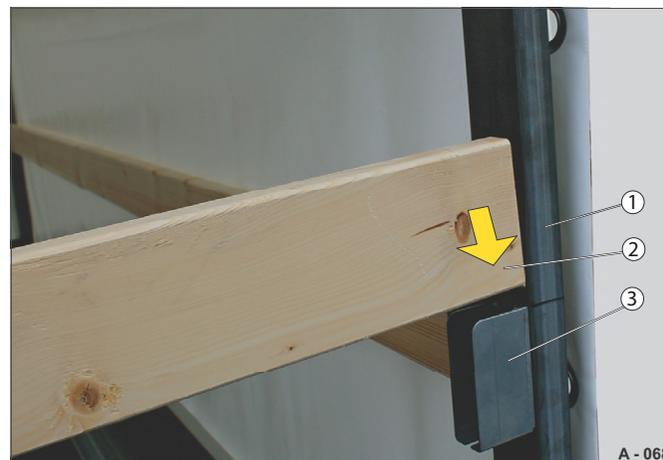
Fig. 79 Insertion de la latte (par ex- sur modèle HT)
