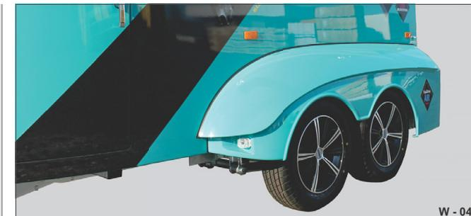
Fig. 98 Surfaces en PRV (plastique à renfort de verre)
