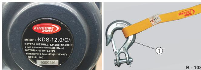
Fig. 42 Exemple : plaque signalétique du fabricant
