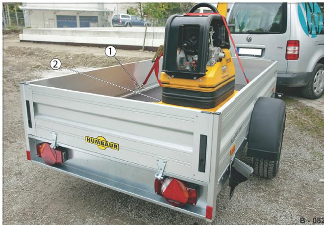
**Fig. 65** Exemple : arrimage de chargement fixe
