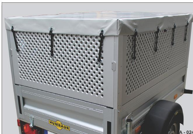
Fig. 49 Sur rehausse en tôle perforée
