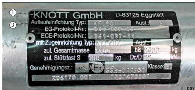
Fig. 23 Exemple : plaque en tôle dispositif de freinage à inertie
