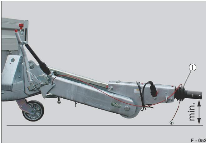
Fig. 49 Hauteur min. du timon réglable en hauteur
