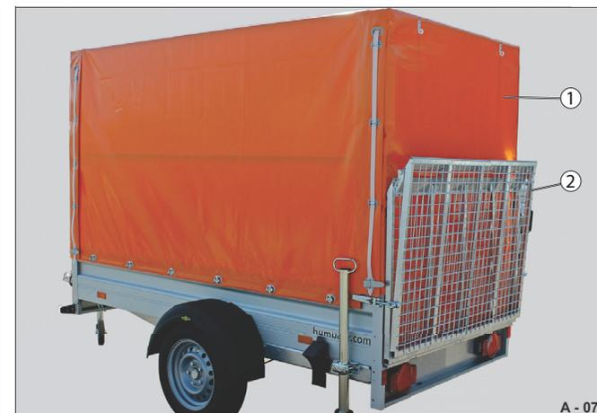
Fig. 83 Bâche haute fermée (en position de conduite)
