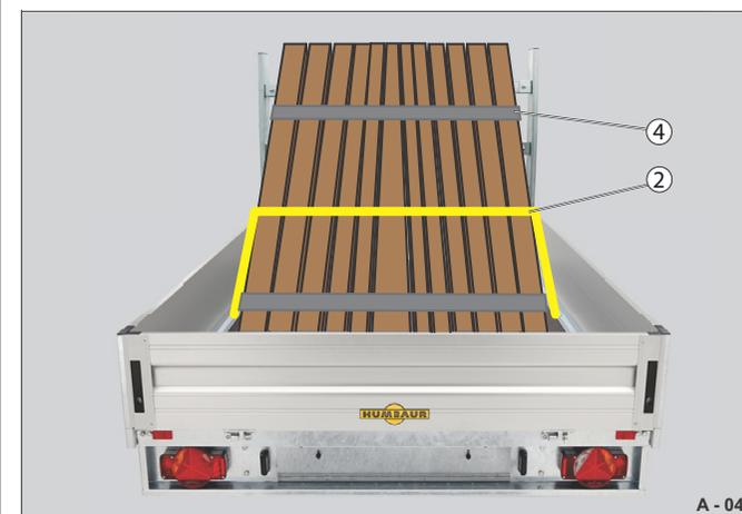
Fig. 39 Arrimage du chargement avec le bâti en H
