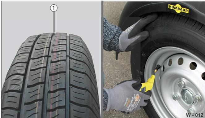
Fig. 14 Contrôle de la pression des pneus
