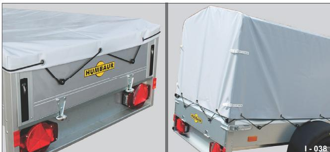
**Fig. 48** Bâche plate / bâche haute avec arceaux
