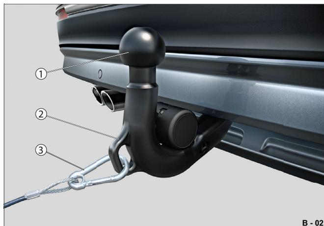
Fig. 21 Exemple : câble de rupture avec mousqueton fixé
