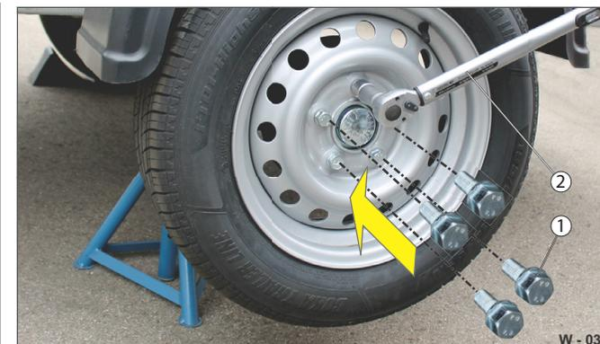
**Fig. 32** Montage de la roue de secours
