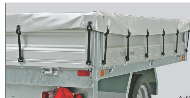
Fig. 56 À l'arrière : câble tendeur avec crochet
