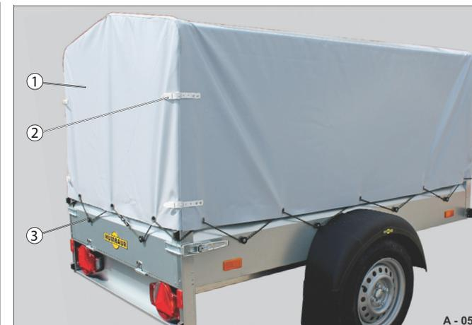
**Fig. 63** Patte de fermeture / sandow
