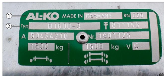
Fig. 25 Exemple : plaque signalétique essieu AL-KO freiné
