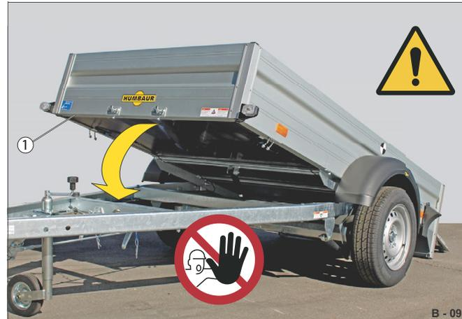
Fig. 29 Accès à la surface de chargement basculée
