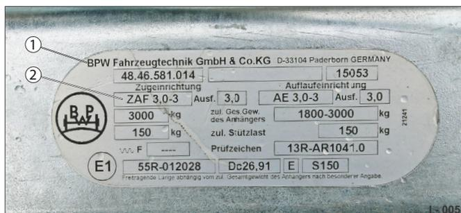
Fig. 21 Exemple : autocollant dispositif de freinage à inertie
