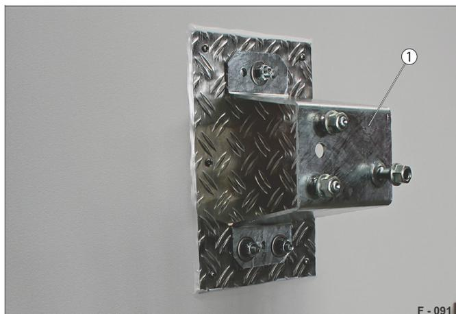
**Fig. 85** Support de roue de secours monté
