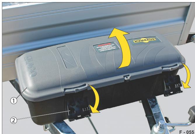
Fig. 79 Déverrouillage de la caisse à outils
