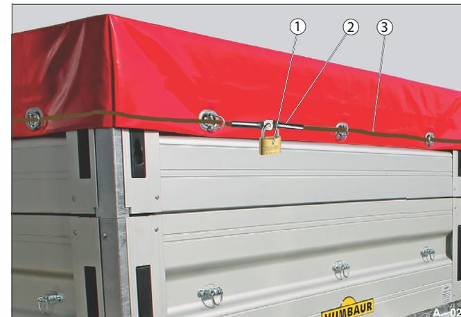
Fig. 60 Sécurisation du câble TIR pour éviter les vols
