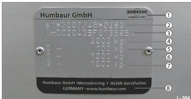
Fig. 16 Exemple : plaque en tôle rivetée
