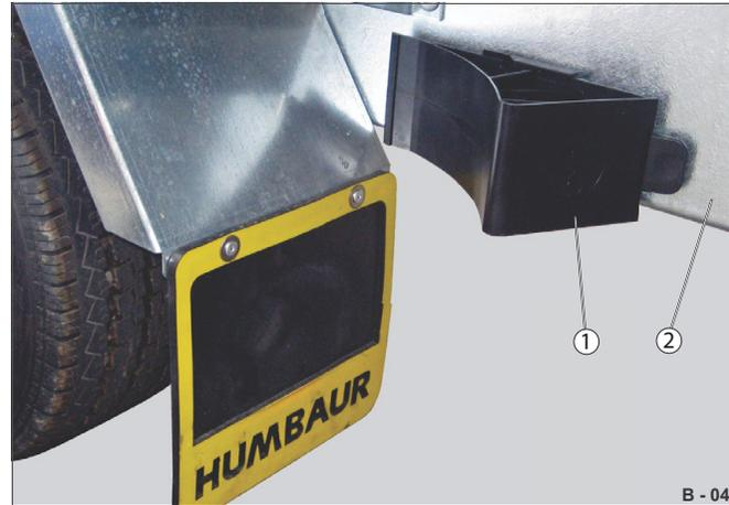
Fig. 77 Exemple 2 : cale fixée horizontalement sur le côté
