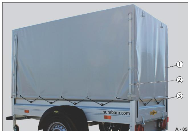
**Fig. 62** Sécurisation à l'aide de sangles / d'un sandow
