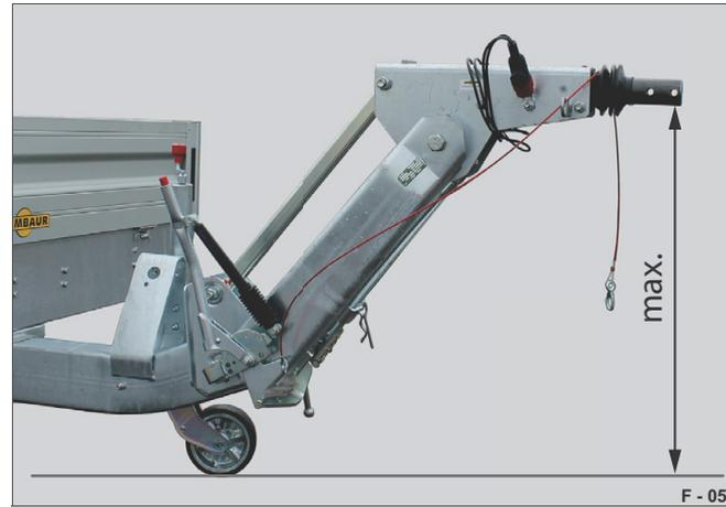
Fig. 50 Hauteur max. du timon réglable en hauteur
