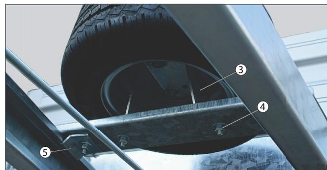
Fig. 18 Fixation de la roue de secours
