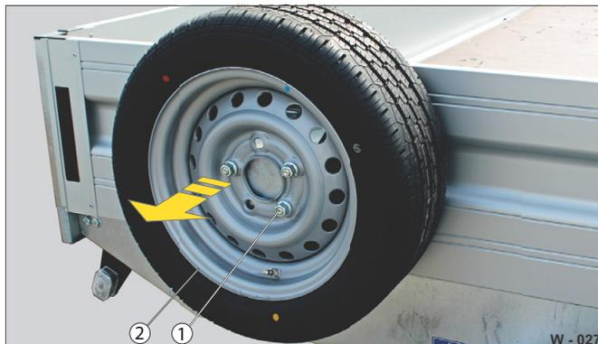
Fig. 28 Retrait de la roue de secours
