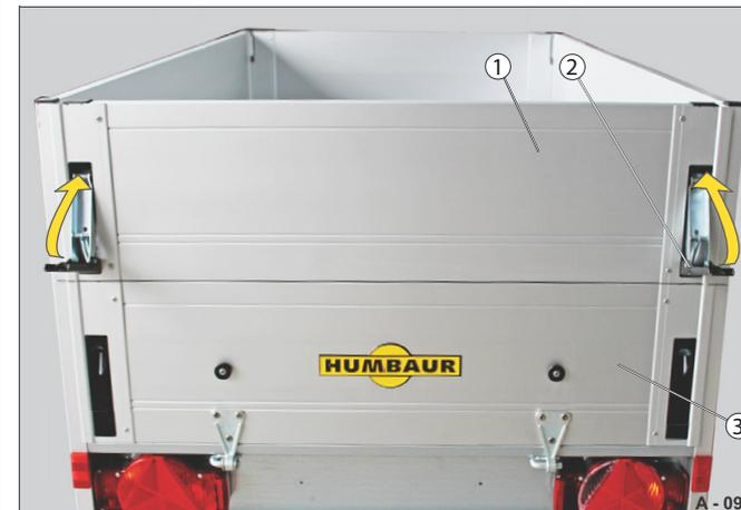
**Fig. 27** Montage d'une rehausse de ridelle arrière / avant
