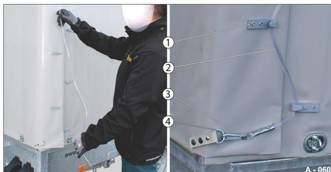
Fig. 68 Sécurisation du câble en zigzag
