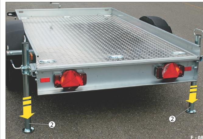
Fig. 21 Positionnement des béquilles en vue du déchargement
