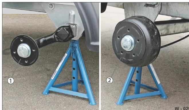
**Fig. 31** Moyeu sans roue
