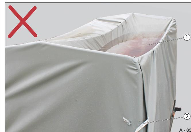
Fig. 66 Exemple : accumulation d'eau sur une bâche haute
