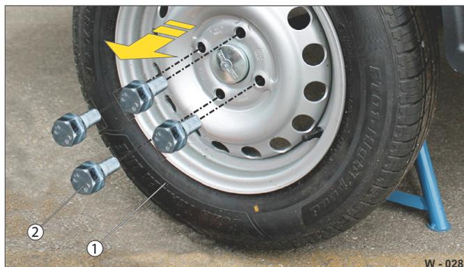
**Fig. 30** Démontage d'une roue défectueuse
