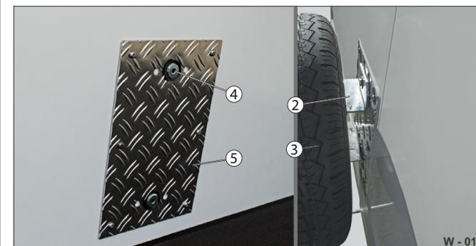
Fig. 20 Fixation de la roue de secours
