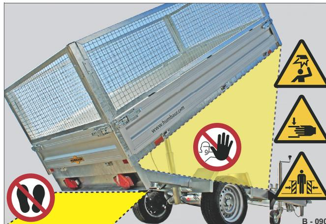
Fig. 27 Zone à risque d'une benne
