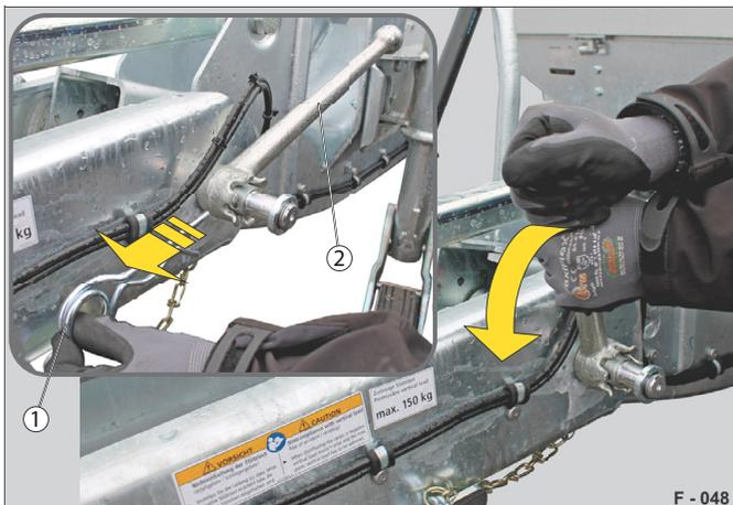
**Fig. 46** Desserrage du garrot de blocage
