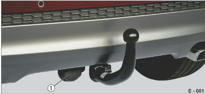
**Fig. 1** Raccordement électrique sur le véhicule tracteur (voiture)
