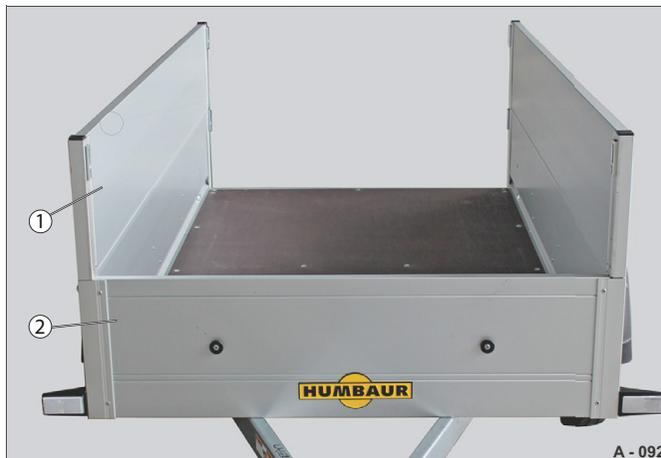
**Fig. 26** Ridelle arrière / rehausse de ridelle démontées
