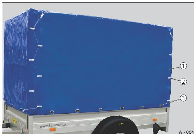
**Fig. 61** Sécurisation par câble en zigzag / tourniquets
