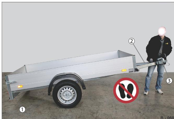
Fig. 71 Manœuvre avec une remorque non freinée
