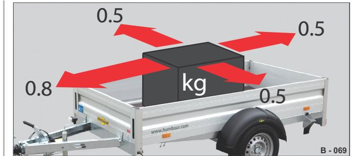
Fig. 54 Forces d'arrimage contre le glissement
