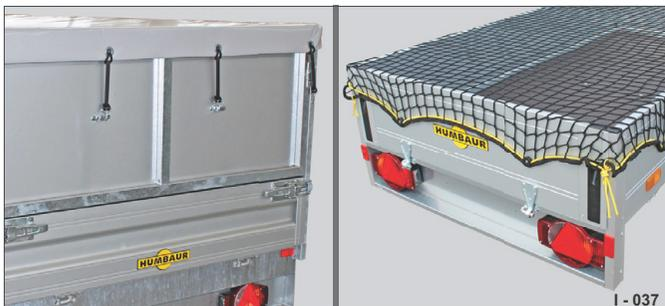
**Fig. 47** Bâche plate sur superstructures / filet de couverture
