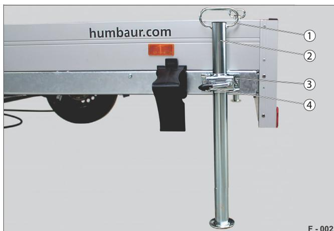
Fig. 25 Béquille coulissante (position d'appui)
