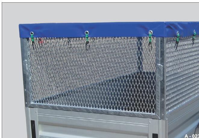
Fig. 48 Sur rehausse grillagée en acier
