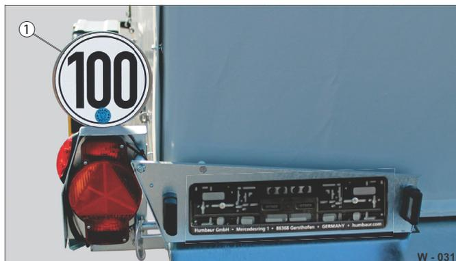
**Fig. 33** Plaquette d'homologation pour une vitesse de 100 km/h
