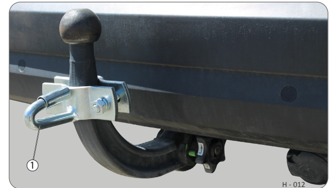
Beispiel: Kupplung mit Klemmvorrichtung
