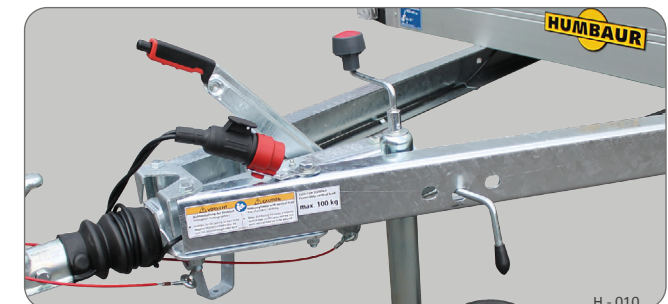
Handbremse gelöst (Fahrstellung)
