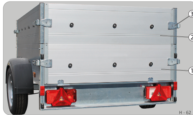
Beispiel: Bordwandaufsatz 1-fach (STARTRAILER PLUS)
