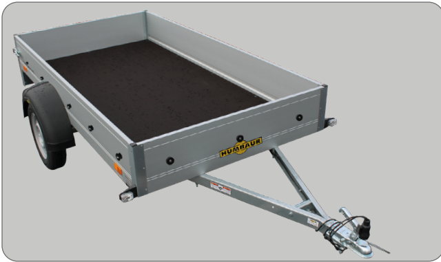
Gesamtansicht: Grundmodell H752513 - ungebremst
