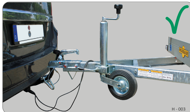
Beispiel: Anhänger ungebremst, angekuppelt
