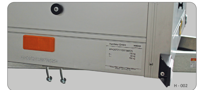
Beispiel: FIN-Nummer eingraviert / Typenschild
