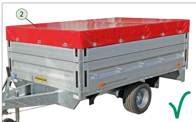
Mit Flachplane gesichert
