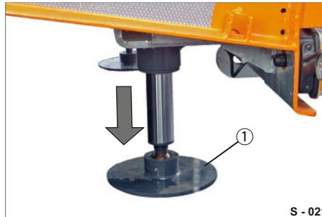
**Abb. 21** Stützen abgelassen
