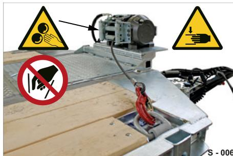
Abb. 8 Gefahrenstellen an Seilzugwinde
