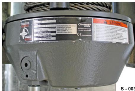
Abb. 3 Typenschild auf der Seilzugwinde
