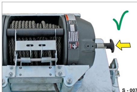
Abb. 9 Kupplungshebel eingerastet
