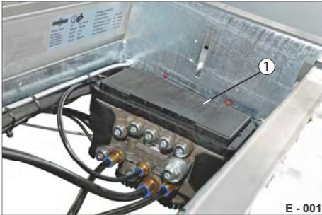
Fig. 1 Brake module, programmable
