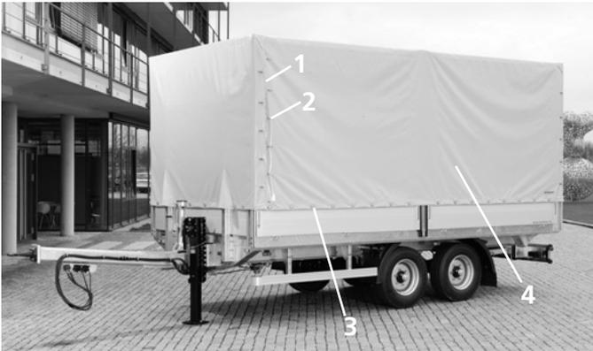
HT mit Spriegelaufbau und Plane
