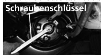
Federspeicher mit Schraubenschlüssel
