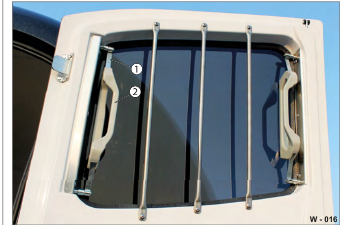
Fig. 16 Vent window in door
