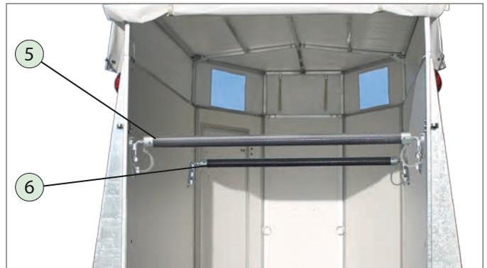
Barres de poitrail et de recul en position « conduite »
